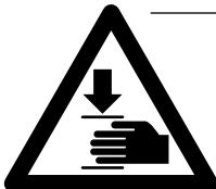
**En raison des risques d'accidents, il est strictement interdit de travailler en cours d'exploitation entre la culasse / les colonnes !**
