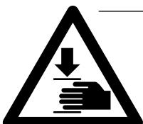
**Wegen Verletzungsgefahr ist das Hantieren zwischen dem Joch / Säulen während des Betriebes verboten !**
